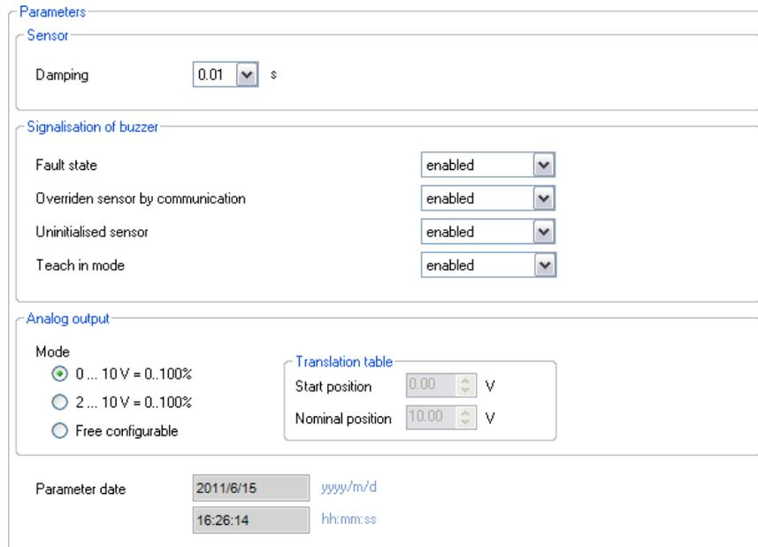
Fig. 29 GUI: Parameters SGU100
